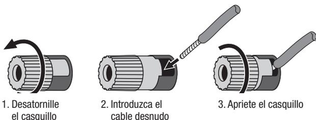
Los conectores banana se insertan en el orificio de en medio de la cabeza del terminal, como se muestra a continuación:
